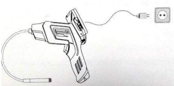
После полной зарядки вы можете продолжать использовать устройство до 4 часов. Когда батарея разряжена, на дисплее появится сообщение «Low Battery». Затем нужно просто вставить адаптер питания и подключить его к розетке для зарядки аккумулятора. (Не используйте зарядное устройство 12В).
