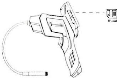
2. Нажмите и удерживайте кнопку включения / выключения, подсветка камеры загорится, а затем нажмите кнопку регулировки яркости светодиода, чтобы отрегулировать яркость подсветки камеры.
