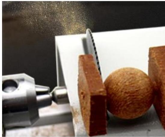
2. Использование пильного диска. Соедините шпиндель и крепление пильного диска вместе. Винт перед пильным диском следует затянуть, чтобы избежать отрыва. Поместите пильный диск в держатель для резки. Рекомендуется использовать пильный диск для последовательного разделения после завершения обработки всей деревянной заготовки.
