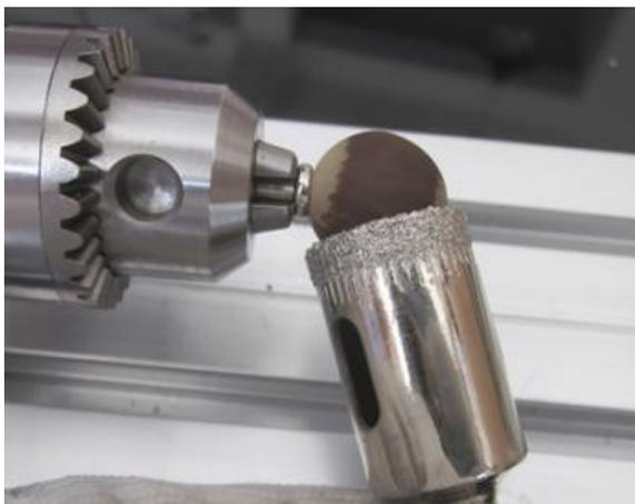
5. Использование фиксатора. Ручное устройство для обработки шарообразных объектов разных размеров. Не рекомендуется прилагать излишнее усилие.
