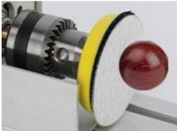
3. Установка и использование шлифовального диска. Приклейте шлифовальную наждачную бумагу на шлифовальную пластину. Закрепите шлифовальную пластину в патрон дрели. Включите станок. Проведите шлифовку, поднеся объекты к бумаге. Снимите отшлифованные элементы и отполируйте их.
