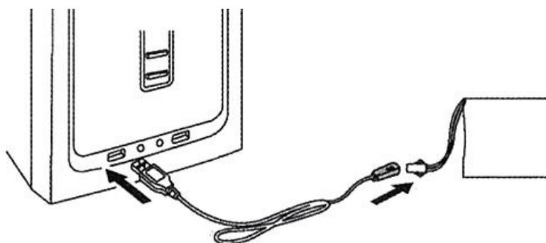
Подключите аккумулятор к зарядному кабелю, затем подключите USB-кабель для зарядки к USB-порту компьютера или USB-зарядному устройству. Затем включите питание. Когда горит красный индикатор, это означает, что идет зарядка, а когда красный индикатор не горит, это означает, что аккумулятор полностью заряжен.
