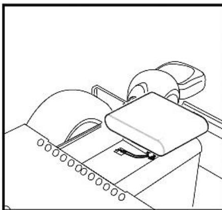
После завершения зарядки корпус разбирается и аккумуляторный блок помещается в аккумуляторный отсек.
